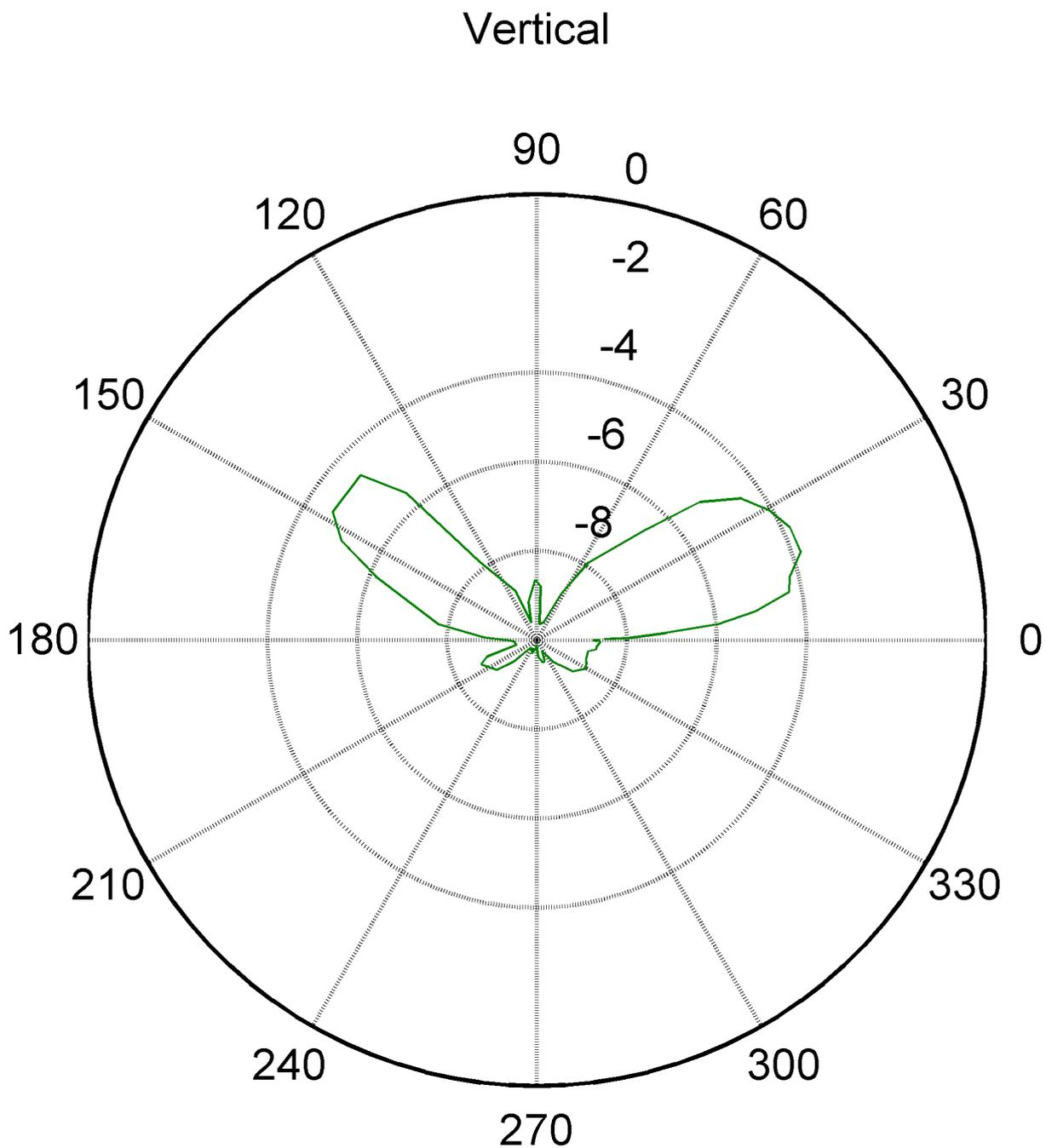
Bild 1: 360° Abstrahlcharakteristik eines Senders
